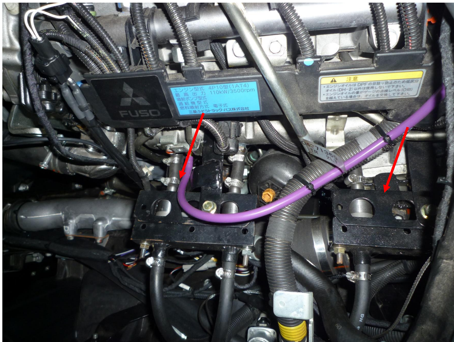
LPGインジェクターはマニホールド部分に各気筒1本ずつ取付
