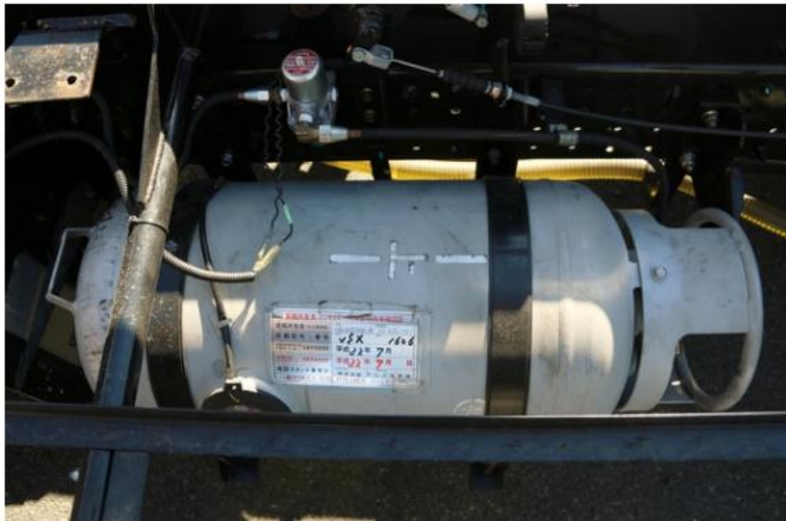
車両には、軽油の燃料タンクとともに、LPGのボンベも搭載されています
