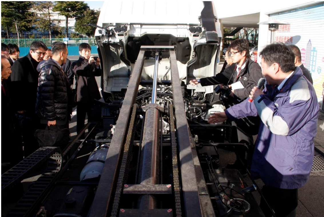
セミナーの後は、鈴木さんが司会をしながら野外でトラックの見学。 「左側に見えるボンベが LPG の燃料タンクになります。」
