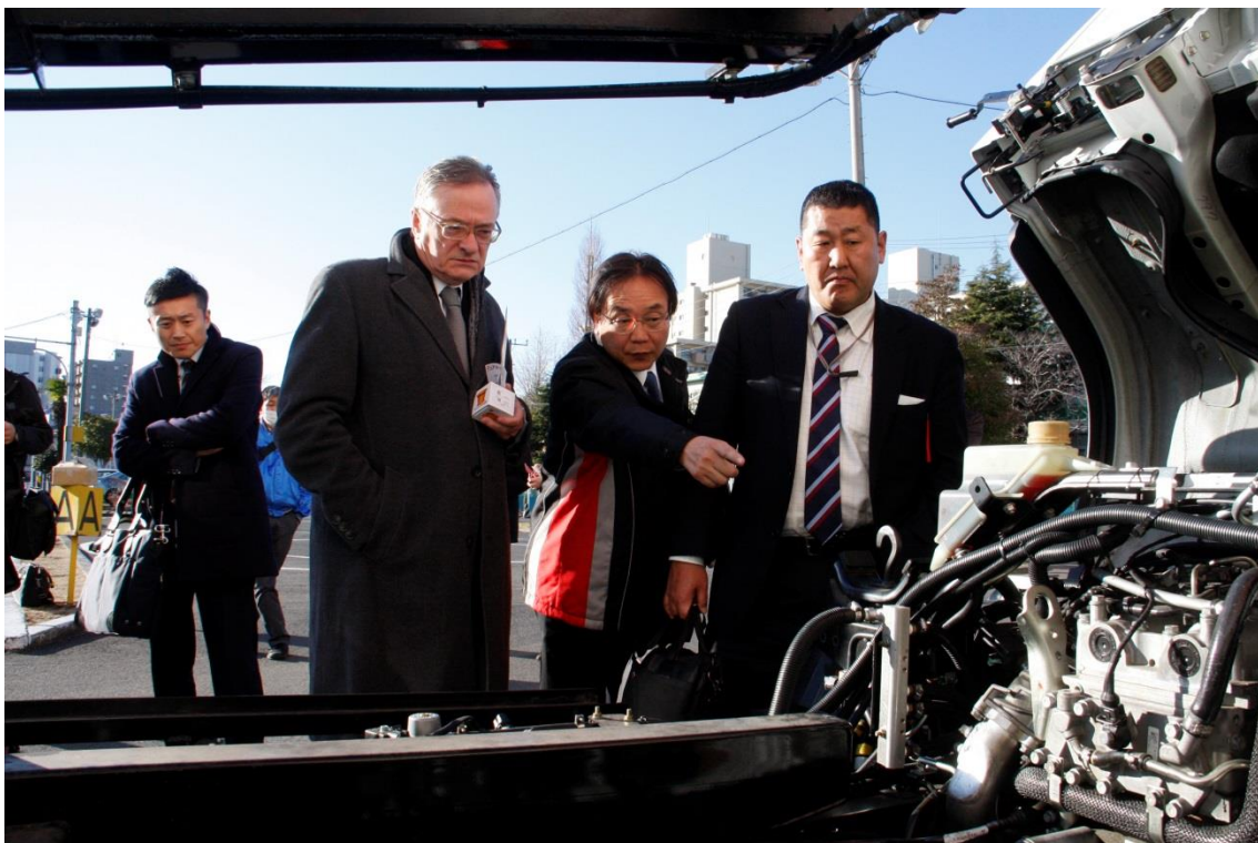
小島エンジニアも英語でトラックの説明。 「We added LPG components to the original diesel engine system.」
